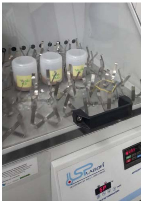
Figura 8 – Visualização das amostras de solo no equipamento agitador orbital, após a adição da solução ácida.
