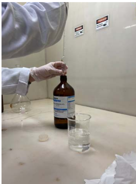
Figura 6 – Visualização do preparo da solução ácida de HCl, que será utilizada para o tratamento das amostras de solo.
