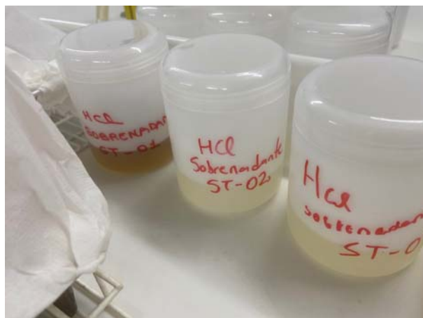
Figura 12 – Visualização dos frascos plásticos contendo o sobrenadante do tratamento das amostras ST-01, ST-02 e ST-03 com solução ácida.
