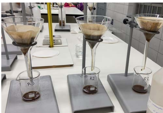
Figura 16 – Visualização da filtragem das amostras ST-01_R1, ST-01_R2 e ST-01_R3 para remoção da porção argilosa.
